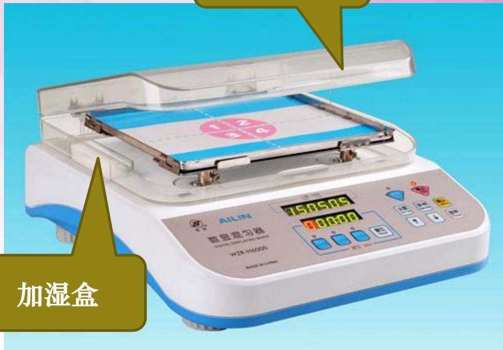
水平旋转仪/水平摇床
